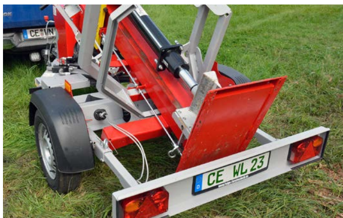
Durchdacht: Staplertaschen im Fahrwerk zum Umsetzen der Maschine. Unten: Der Holzspalter in Transportstellung mit angebaute Beleuchtung.
