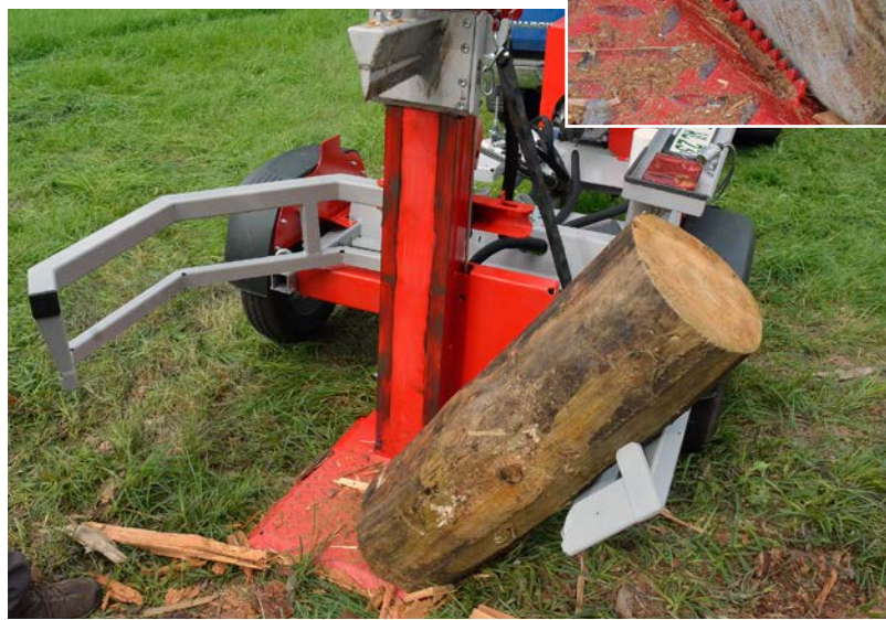
Meterholz wird mit dem Sappie beigezogen (oben), der Stammheber richtet es auf. Eine Zackenleiste an der Bodenplatte fixiert dabei das Holz (kleines Bild). Weiträumige Haltebügel erleichtern die Holzablage direkt am Spalter (unten).
