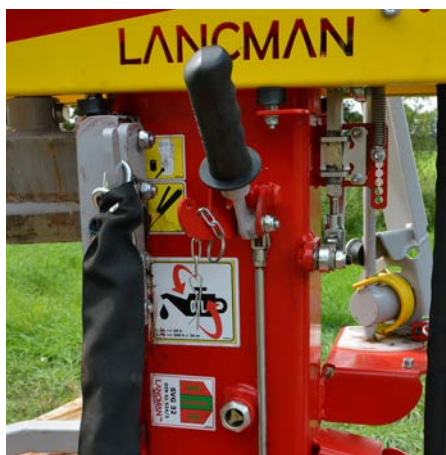
Robuster slowenischer Maschinenbau: Links die Stammheber-Mechanik mit der federbelasteten Haltekralle im Hintergrund, rechts die weitgehend spiellosten Gestänge der Spalter-Mechanik.
