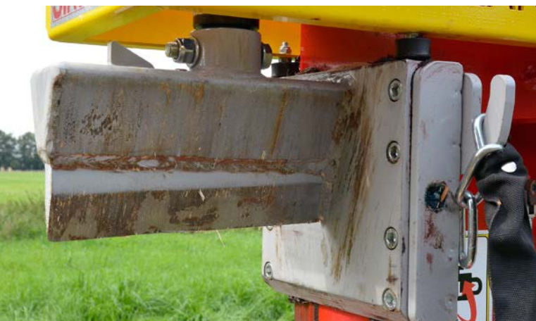
Mit dem Kurzholztisch ist der LANCMAN STAWX17 ein luxuriöser Kurzholzspalter. Unten: Der Spaltkeil auf der Führung entlang der Spaltsäule.
