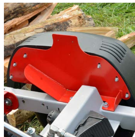
Zusätzlich geschützt sind die verstärkten Radkästen. Fotos: Riemann
