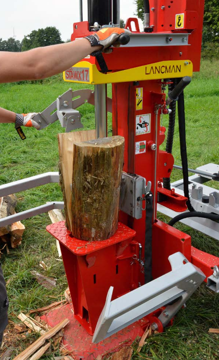
Mit dem Kurzholztisch ist der LANCMAN STAWX17 ein luxuriöser Kurzholzspalter. Unten: Der Spaltkeil auf der Führung entlang der Spaltsäule.
