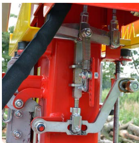
Robuster slowenischer Maschinenbau: Links die Stammheber-Mechanik mit der federbelasteten Haltekralle im Hintergrund, rechts die weitgehend spiellosten Gestänge der Spalter-Mechanik.
