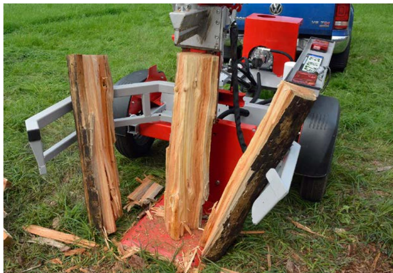
Meterholz wird mit dem Sappie beigezogen (oben), der Stammheber richtet es auf. Eine Zackenleiste an der Bodenplatte fixiert dabei das Holz (kleines Bild). Weiträumige Haltebügel erleichtern die Holzablage direkt am Spalter (unten).
